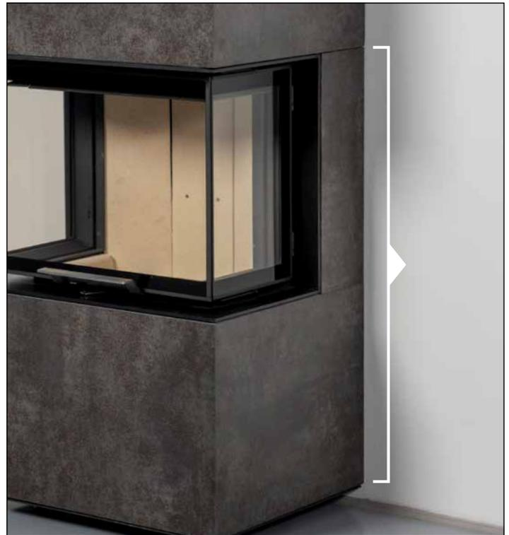
Ausrichtung der Verkleidung – Spalt minimieren. In der Regel ist nun ein Spalt zwischen dem seitlichen und oberen Keramikelement sichtbar. Dieser kann verringert werden, indem das seitliche und untere Keramikelement zusammen mit den Justierschrauben nach oben gedreht wird. Die Verkleidung mittels der vorab herunter gedrehten Justierschrauben so ausrichten, sodass sich der Spalt zwischen den einzelnen Elementen verringert.
