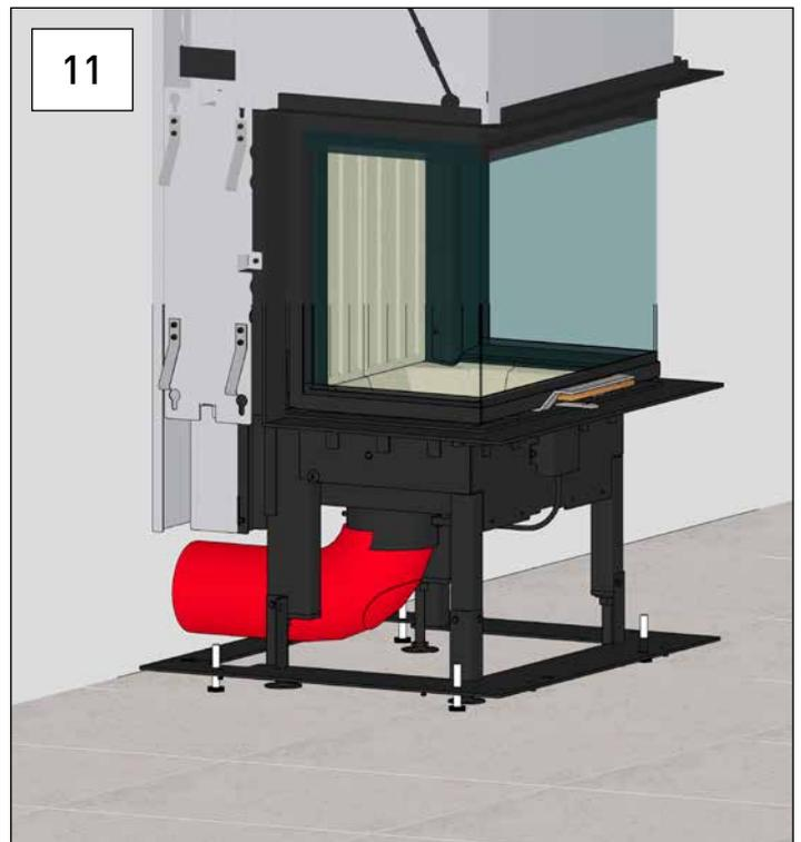
11 Verbrennungsluft hinten.
