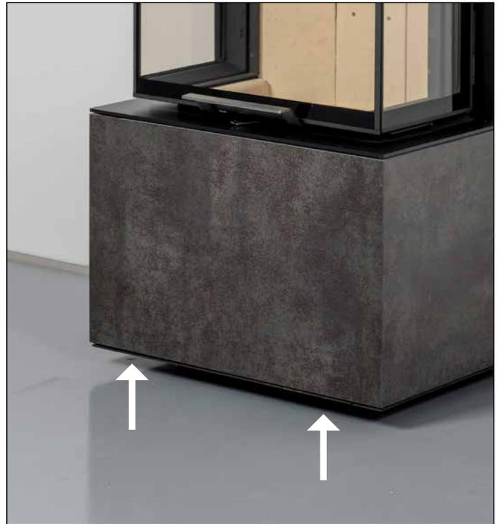
Fixierung unteres Keramikelement – Nach Ausrichten der Verkleidung, die zuvor lose angezogenen Fixierschrauben unten in der Sockelplatte festschrauben.
