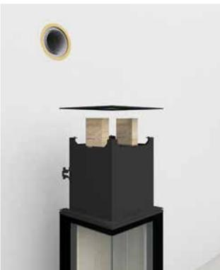
Bei einem Rauchrohrabgang oben muss zuerst die Topplatte auf zwei Abstandshalter mit einer Höhe von ca. 10 cm gelegt werden. Anschließend kann das Rauchrohr durch die Topplatte an dem Rauchrohrstutzen befestigt werden. Nun kann der Heizeinsatz nach hinten geschoben und der Rauchrohrabgang hergestellt werden.
