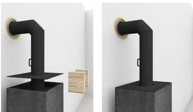
Bei einem Rauchrohrabgang oben müssen zunächst die Abstandshalter entfernt und danach kann die Topplatte vorsichtig oben auf den Heizeinsatz gelegt werden (ohne dass das Rauchrohr verkratzt wird). Hierbei ist darauf zu achten, dass die vier angebrachten Bolzen der Topplatte in die vorgesehenen Löcher geführt werden.
