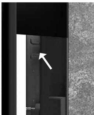
Auf der rechten und linken Innenseite (hinten) der Verkleidungselemente sind jeweils ein Bolzen mit Mutter vormontiert. Dieser befindet sich im montierten Zustand in einer Halterung, wodurch das Verkleidungselement mit der Mutter fixiert werden kann. Wenn das Element richtig positioniert ist, dann auf der Rückseite innen jeweils die Muttern auf der rechten und linken Seite festschrauben.
