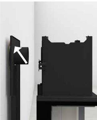
Bei einem Rauchrohrabgang hinten muss zuerst das Rauchrohr in das Wandfutter gesteckt werden. Anschließend die Stahl-Rückwand über das Rauchrohr schieben. Hierzu muss zwischen Rauchrohr und Stahl-Rückwand z.B. ein Stück Karton geklemmt werden, um Verkratzungen zu vermeiden (s. Pfeil). Nun kann der Heizeinsatz nach hinten geschoben und der Rauchrohrabgang hergestellt werden.
